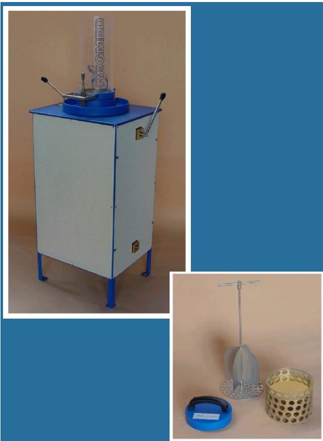
Ręczna formierka arkuszy przeznaczona jest do wykonywania laboratoryjnych arkusików papieru wykorzystywanych w badaniach własności mechanicznych i optycznych.
